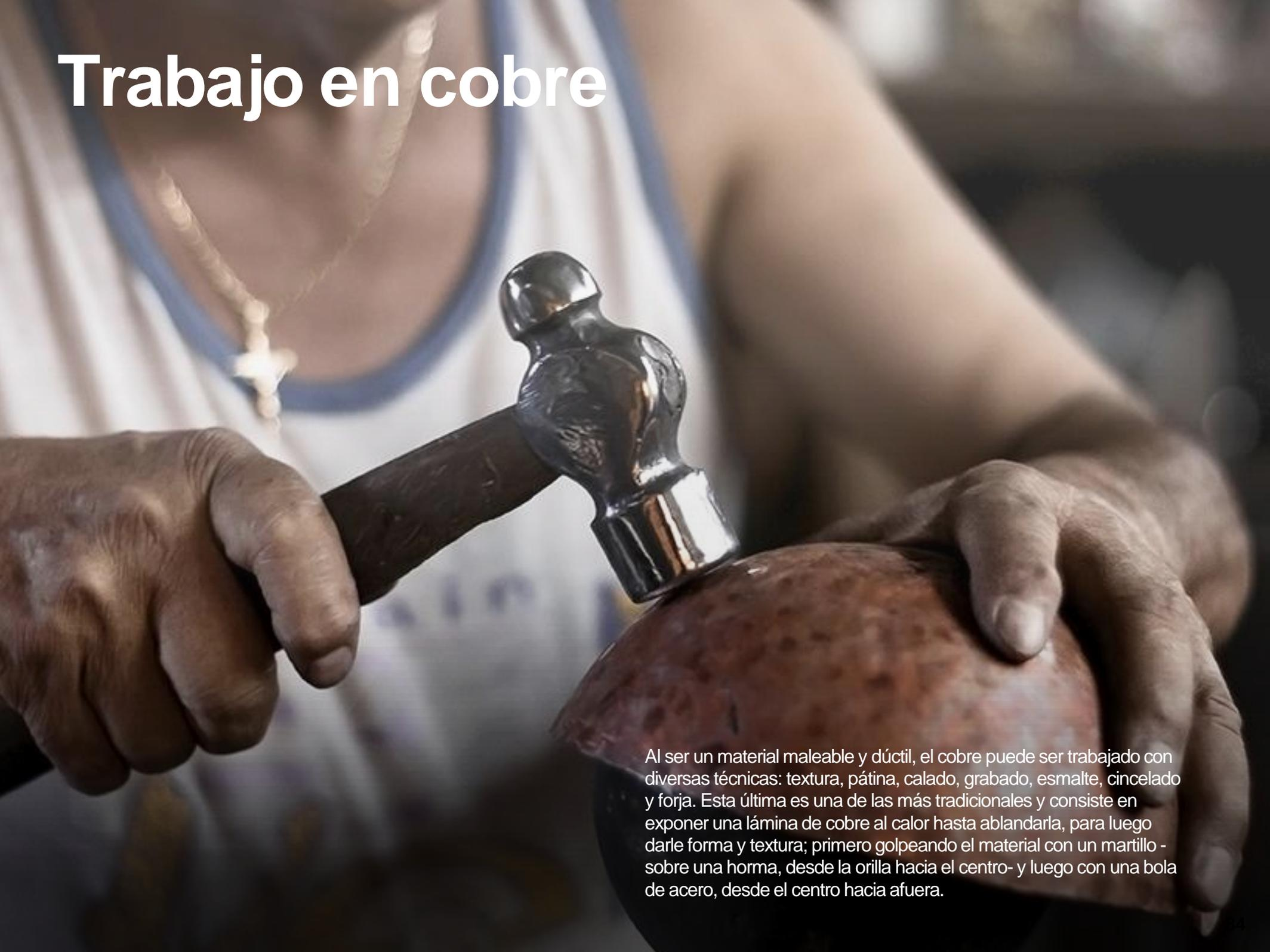
Al ser un material maleable y dúctil, el cobre puede ser trabajado con diversas técnicas: textura, pátina, calado, grabado, esmalte, cincelado y forja. Esta última es una de las más tradicionales y consiste en exponer una lámina de cobre al calor hasta ablandarla, para luego darle forma y textura; primero golpeando el material con un martillo - sobre una horma, desde la orilla hacia el centro- y luego con una bola de acero, desde el centro hacia afuera.
